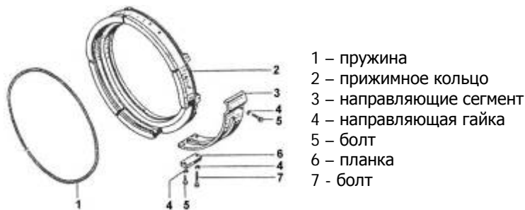
Рисунок 6. Канатоукладчик – развернутый вид.
